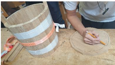
Jetzt werden die Leisten zu einem Eimer gespannt. Wenn alle Fugen dicht aneinander gehen, kann der Boden für den Eimer angepasst und zugesägt werden. Um den Boden im Eimer zu befestigen, wird an jeder Leiste unten eine Nut eingesägt und ausgestemmt.
