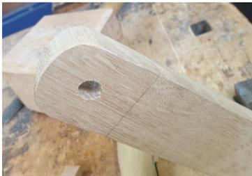
Die zwei Halteleisten werden oben an den Kanten abgerundet. Zusätzlich wird jeweils ein Loch, für die Befestigung des Seils gebohrt.
