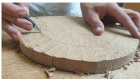
Damit der Boden in die Nut passt, muss die Dicke der Bodenplatte beidseitig an dem äußeren „Kreisring“ schmaler gehobelt werden. Es wird beidseitig ein grober Umriss des äußeren Kreisrings angerissen. An der Kante der Bodenplatte wird mit dem Streichmaß die entsprechende Dicke von oben und unten angerissen. Mit dem Schrupphobel wird die Bodenplatte für die Nut angepasst.
