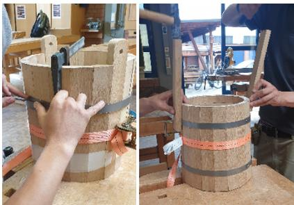
Ist die Bodenplatte in den Eimer eingesetzt, werden die Ringe/Riemen abgelängt, vorgebohrt und genietet. Die Riemen werden vom Eimerboden in Richtung Öffnung um den Eimer gehämmert. Die Riemen spannen die Leisten, sodass kein Leim benötigt wird.
